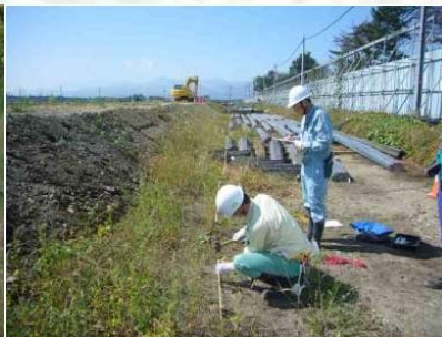
大地抵抗率測定（ウェンナー4電極法）
